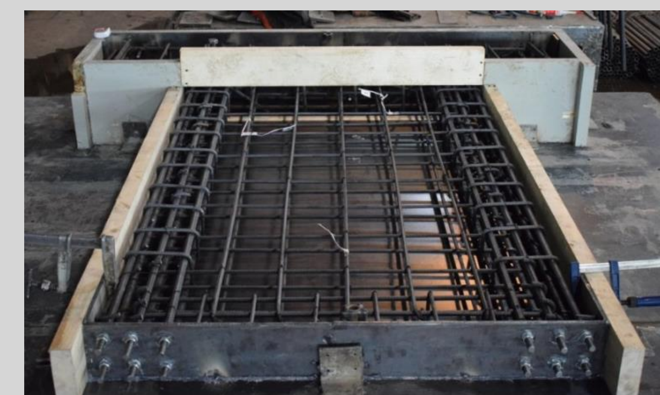
شکل (۵): تصویری از ساخت نمونه با میلگرد متعامد
