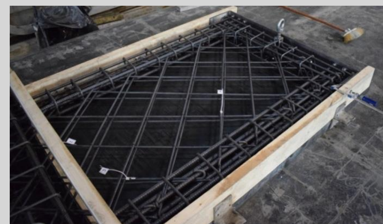
شکل (۳): تصویری از ساخت نمونه با میلگرد مورب
